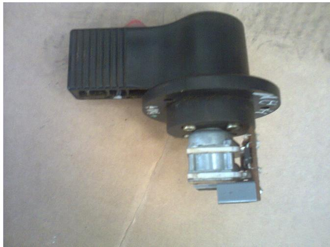
Enlever le verrouillage de la commande en desserrant la vis Allen en plastique ce trouvant dans le bout de la commande puis la retirer. Une fois la commande retiré il faut Dévisser la vis en laiton à empreinte plate se trouvant sur la pièce cylindrique en laiton, dévisser l'écrou du dessus et retirer la pièce en laiton et enfin desserrer l'écrou qui retient le support de la partie électrique
