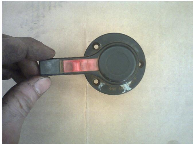
Après il faut dessolder les sept pattes qui retiennent l'interrupteur. Cela ressemble à un potentiomètre mais se sont belle et bien des contacts entre les bornes et non une variation de résistance.
